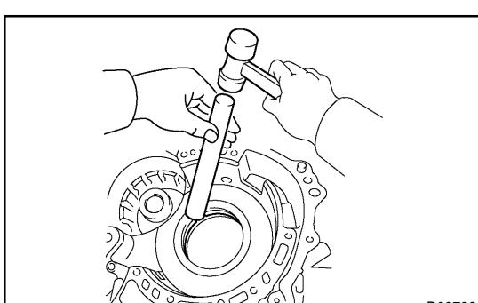
(d) Using a brass bar and a hammer, remove the 2 bearing outer races.
