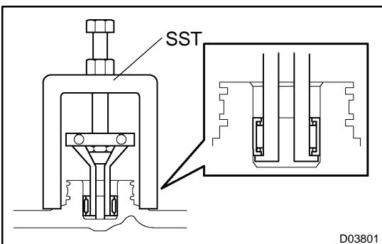
(d) Using SST, remove the needle-roller bearing.
