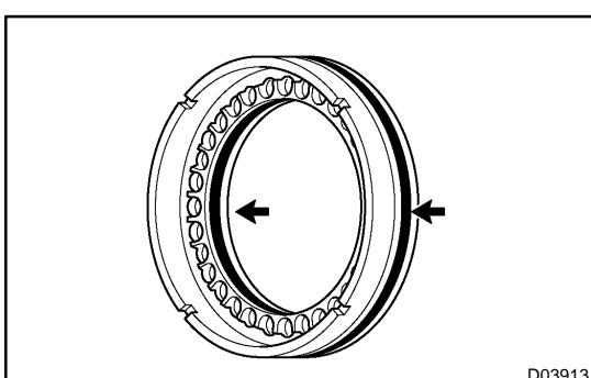
(d) Remove 2 O-rings from the 1st & reverse brake piston.
